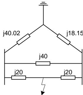
Transformacijom trougla impedansi u ekvivalentnu zvijezdu dobija se zamjenska šema:
