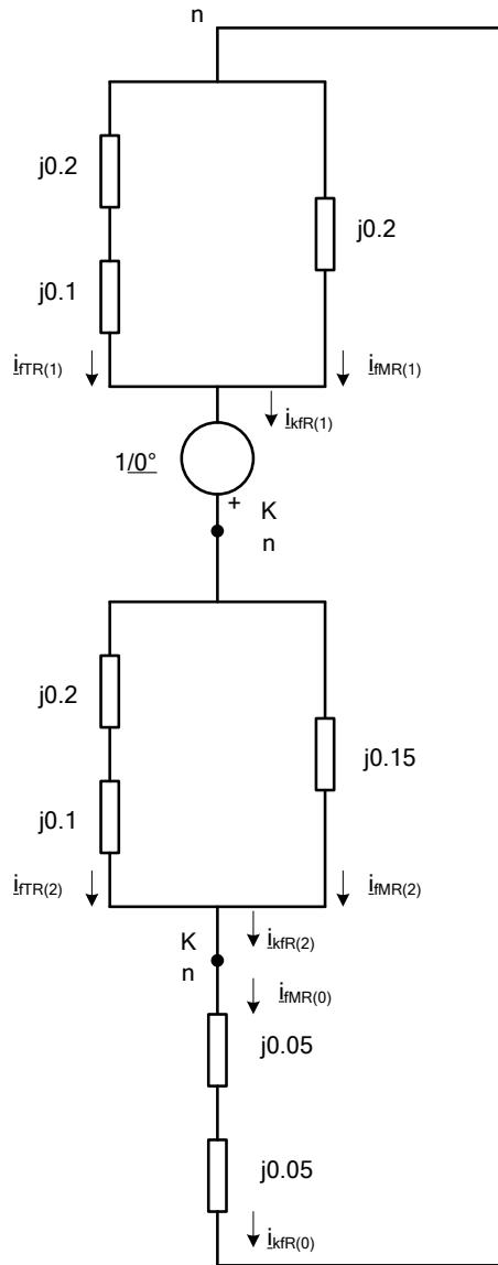
Simetrične komponente struje motora u fiktivnom režimu se određuju kao:
